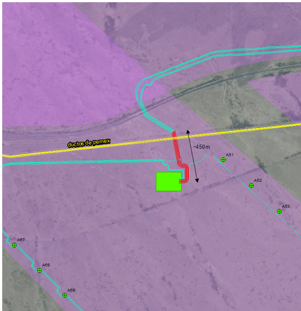
Figura 2.8 Circuitos aéreos desde los ductos de PEMEX hasta la subestación de elevación
