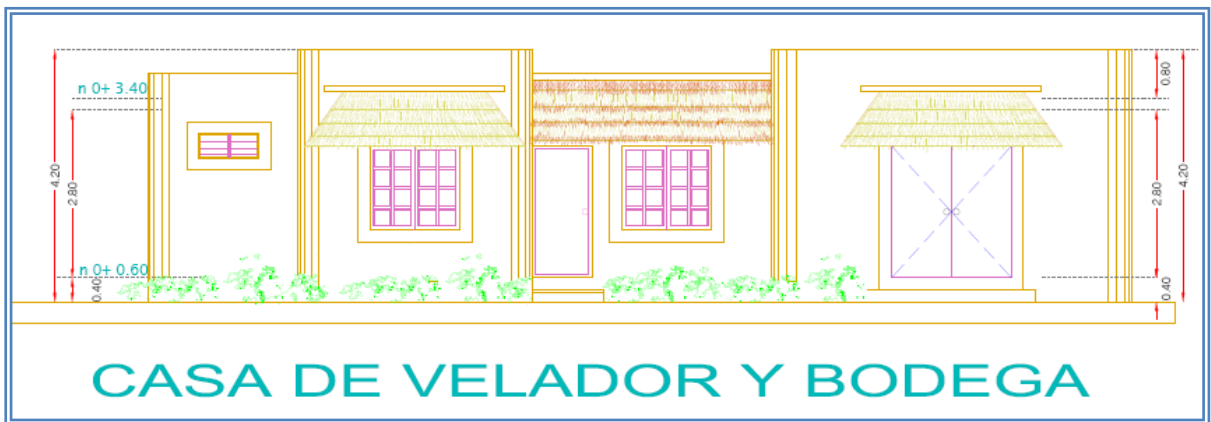
Fachada del módulo denominado Casa del Velador-Bodega, se aprecia la altura de la edificación a 4.20 ml sobre el nivel del suelo natural.
