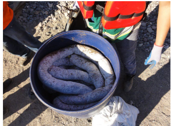
Barrera absorbente a base de musgo y musgo suelto (en la bolsa de plástico), dentro de kit contra derrames.
