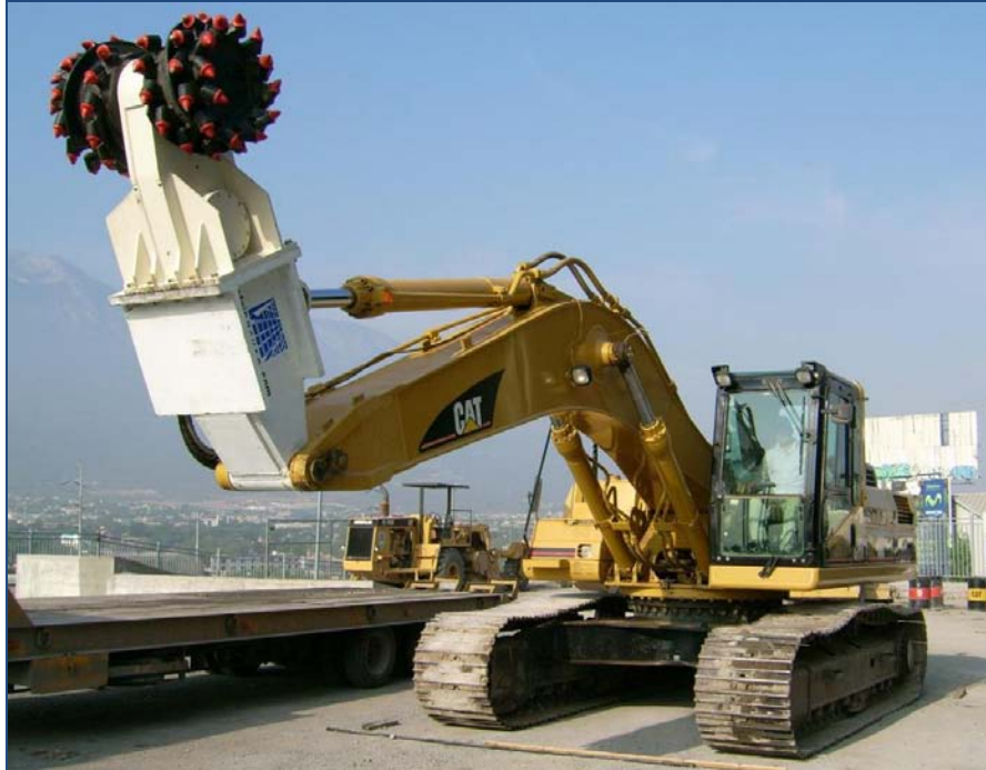
Figura II.17 Rozadora con sistema de corte frontal “ripping”
